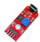
*Capteur:* 801S accéléromètre
